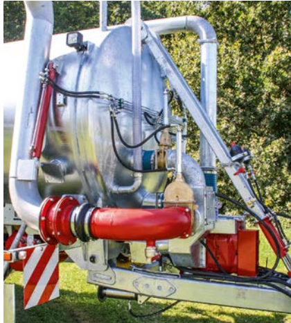
Andockvorrichtung 8" hydraulisch Ø 200 mm mit Trichter
