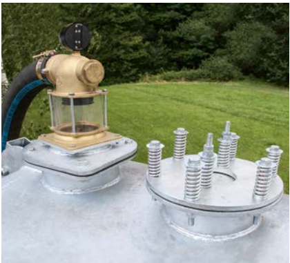
Dohm mit Sicherheitsventil + Unter-/Überdruckventil
