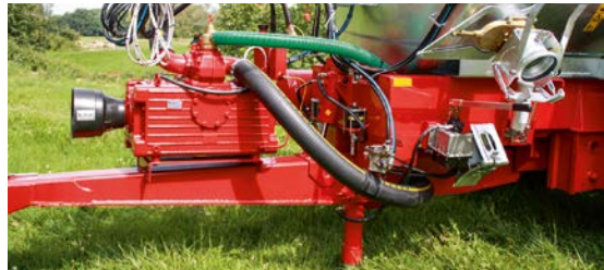
Kompressor mit gefederter Zugdeichsel
