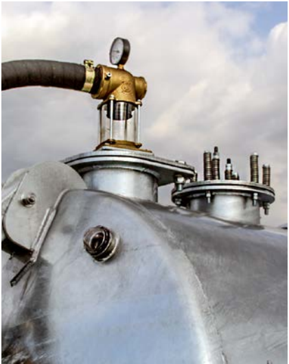
Schauglas an der Stirnwand des Behälters
