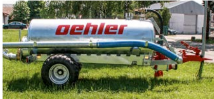
Saugrohr 3 mtr., Saugschlauch 2 mtr.
