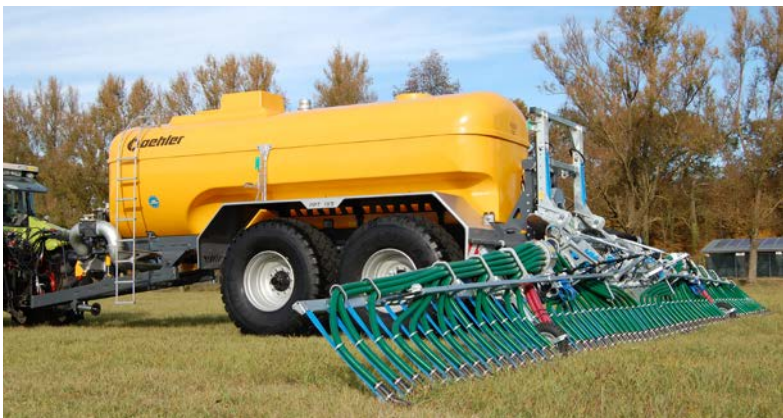
PPT 100 Pumptankwagen mit Schleppschuh
