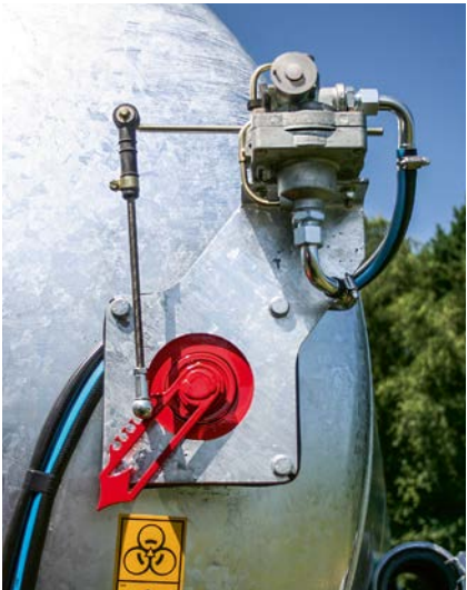
Fassfüllanzeiger mit ALB
