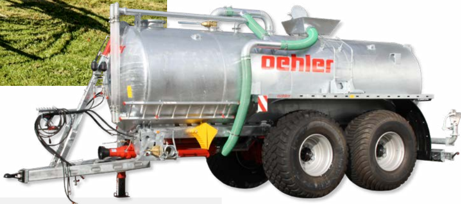
PTT 165 mit Schleppschlauch und Saugarm
