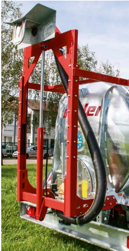
Hydr. verst. Schwanenhalsverteiler
