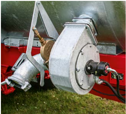
Saugbeschleuniger seitlich vom Fass
