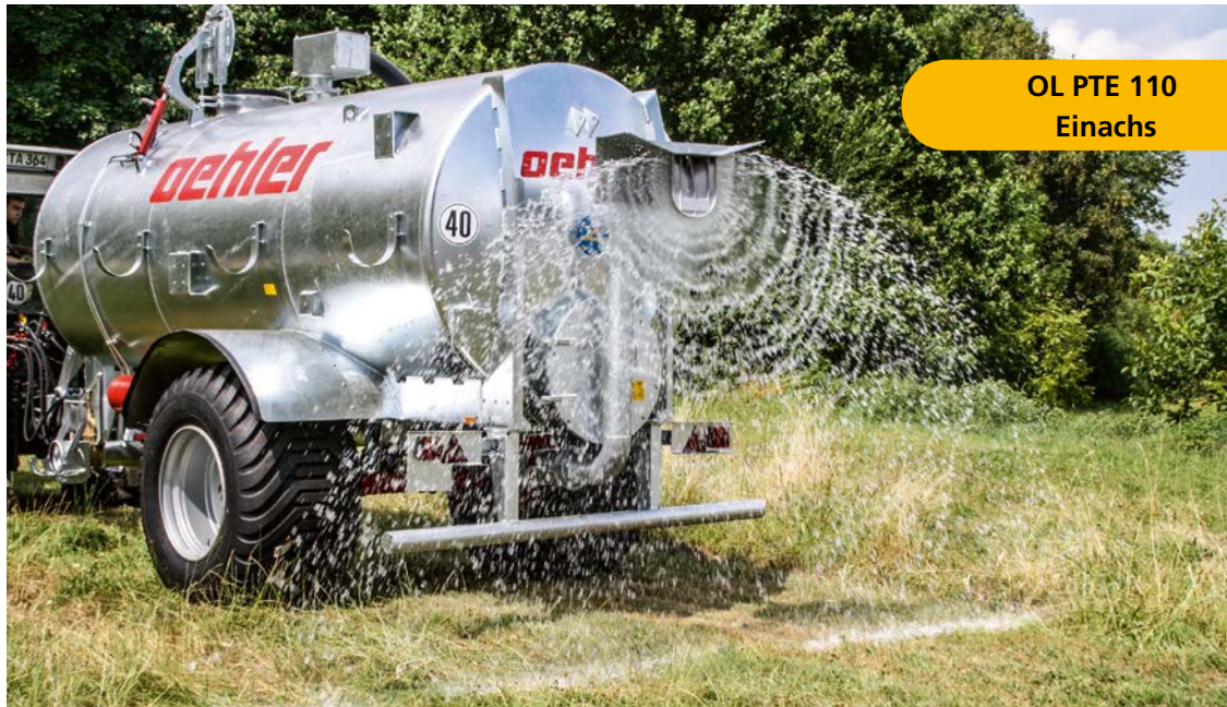
PTE 110 mit Schwanenhalsverteiler
