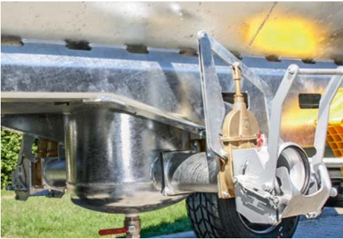
Tiefenentleerung für Andockvorrichtung mit Befüllsystem
