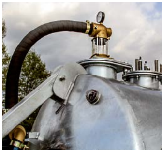
Überdruckventil und Manometer
