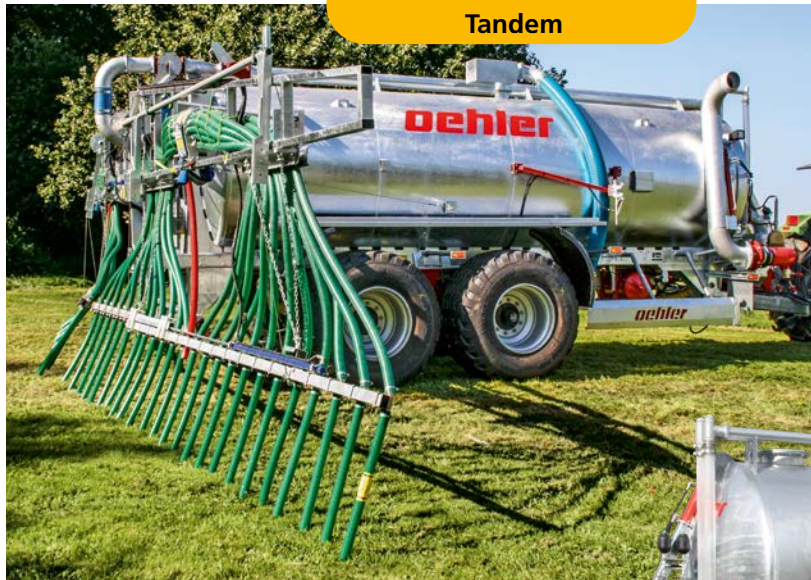
PTT 165 mit Schleppschlauch und Saugarm
