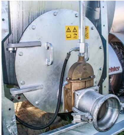
Hydraulische Schieberöffnung und Glockenschieber
