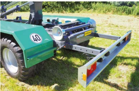
Anbauplatte für Kranaufbau
