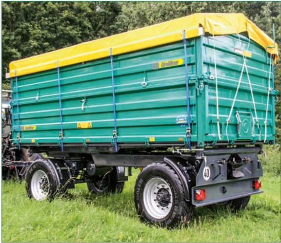
Mit Spriegel und Spanngurten
