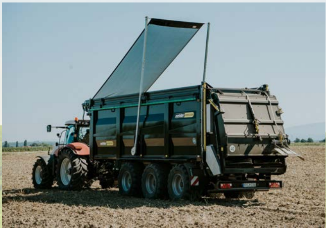
ASW 340 B - Breitstreuwerk und Flip-Tarp Netzabdeckung
