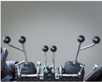
6-fach Steuerung mechanisch
