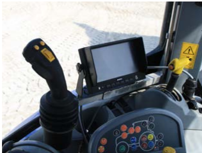
Joystick Steuerung (Option)
