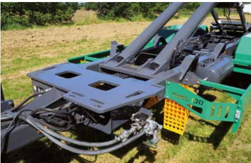
Anbauplatte für Kranaufbau
