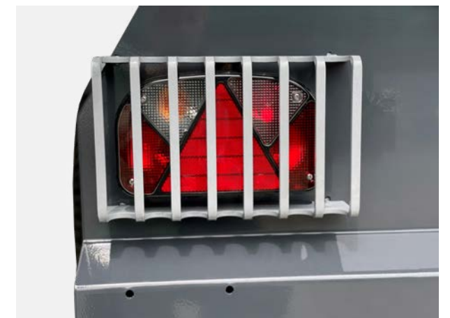
Beleuchtung mit Schutzgitter EDK 20 - EDK 80
