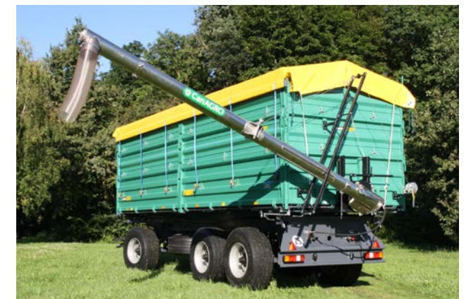
OL DDK 240 mit Kornschnecke
