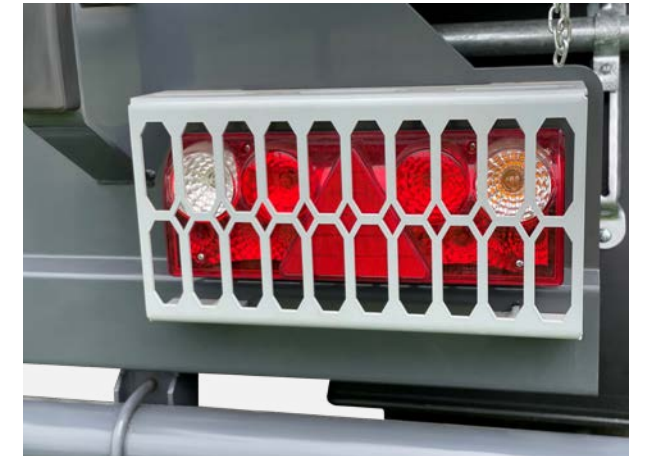
Beleuchtung ab ZDK 180 bis DDK mit Schutzgitter
