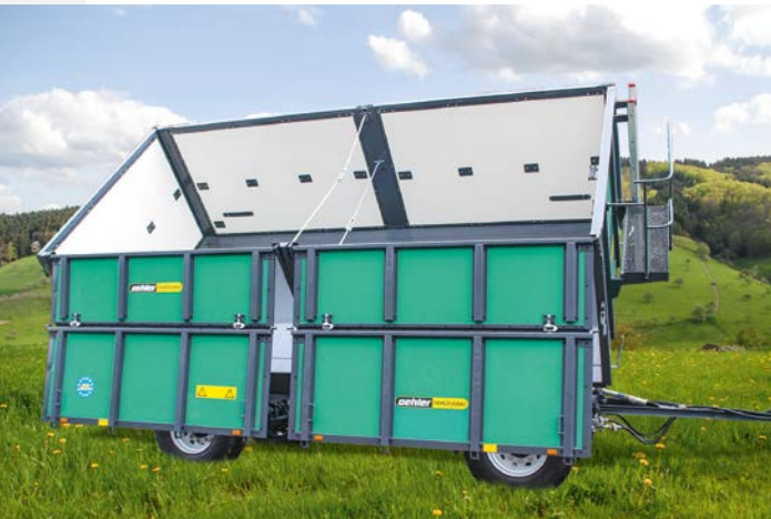
Seitenbordwände horizontal geteilt
