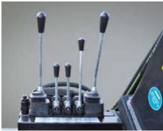
Kreuzhebelsteuerung 7-fach mechanisch
