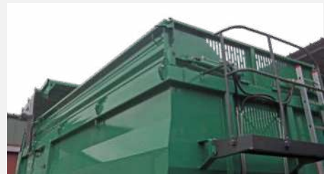
Hydraulisch abklappbarer Aufsatz
