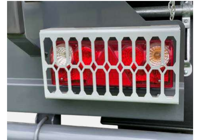
Beleuchtung ab ZDK 180 bis DDK mit Schutzgitter
