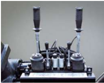
Kreuzhebelsteuerung 6-fach mechanisch, 2-fach elektrisch
