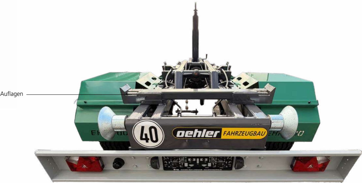
Unterfahrerschutz mit Beleuchtungsanlage
