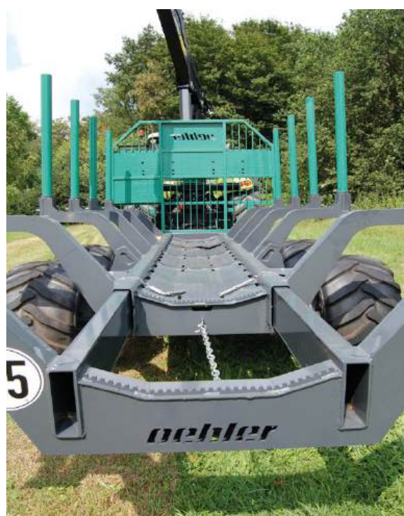
Stabiler und ausziehbarer Doppelrohrrahmen
