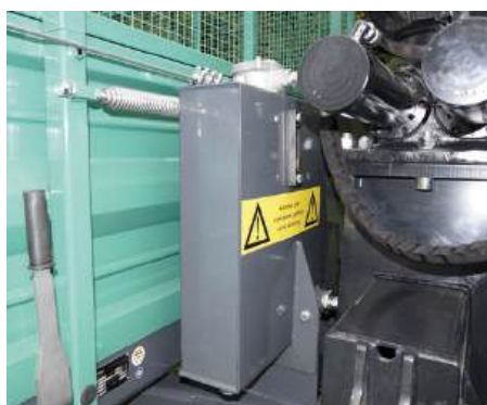
Tank eigene Ölversorgung
