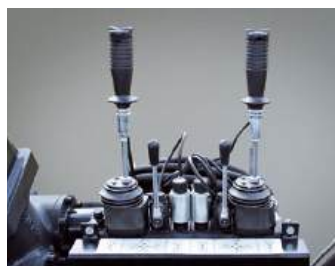
Kreuzhebelsteuerung 6-fach mechanisch, 2-fach elektrisch
