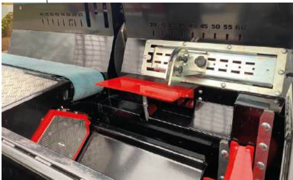
OL 4100 HZ - Schnittlängeneinstellung und Auswurfklappe
