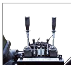
Kreuzhebelsteuerung 6-fach mechanisch 2-fach elektrisch
