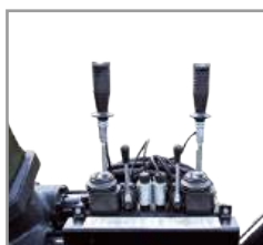
Kreuzhebelsteuerung 6-fach mechanisch 2-fach elektrisch
