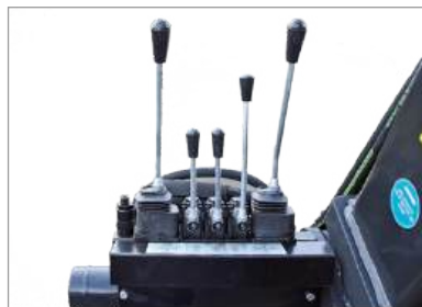
Kreuzhebelsteuerung 7-fach mechanisch
