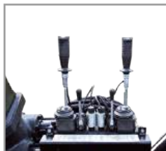
Kreuzhebelsteuerung 6-fach mechanisch 2-fach elektrisch
