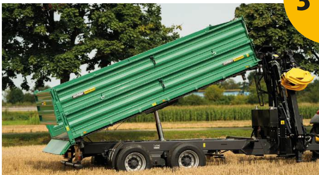
3-Seitenkipper mit 16t zul. Gesamtgewicht, Schotterklappe optional
