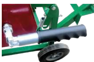
Not-Aus Schaltung für Zapfwelle
