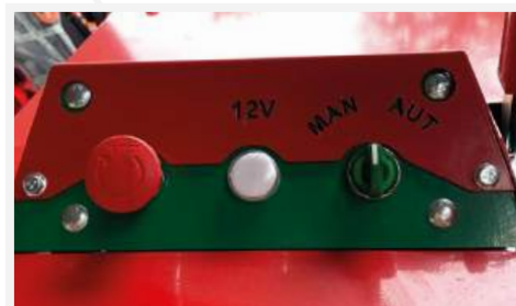
Elektronische Steuerung: Not-Aus-Schalter / Kontrollleuchte und Umschaltechnik
